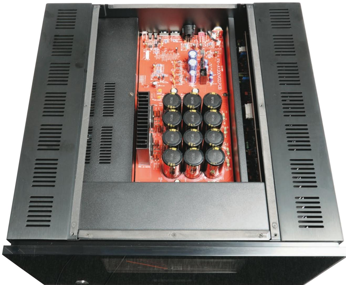
**Composants :** Pour délivrer une puissance de sortie de 450 W sous 8 ohms, ce bloc mono s'appuie sur une alimentation linéaire puissante et efficace, réalisée au moyen de composants de qualité, et dix transistors bipolaires de puissance. Les composants passifs et les actifs prennent place sur une carte électronique unique, rassemblant tous les circuits audio. L'implantation claire et rationnelle constitue un gage de fiabilité.
