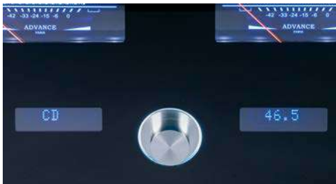
Der mittig auf der Front positionierte Pegelsteller ist multifunktional, er dient der Lautstärke und der Eingangswahl.
