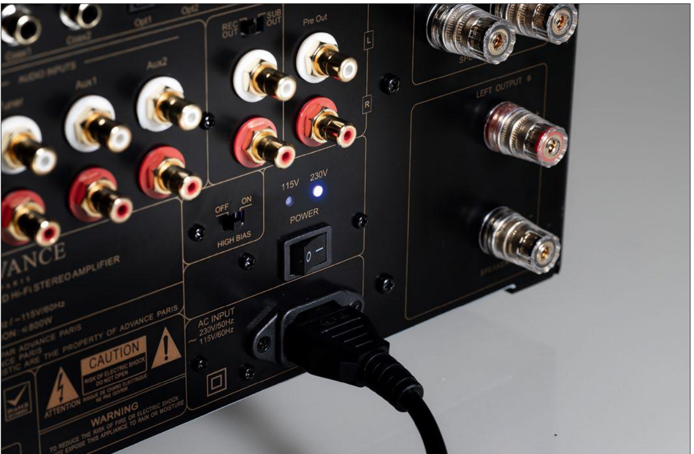
Neben der herausragenden Verarbeitungsqualität der Anschlüsse fällt die an der Rückseite verbaute High Bias-Schaltung auf. Anhand dieses Kippschalters kann der Amp den Eingangspegel an seine eigenen Kapazitäten anpassen und bei Bedarf auf eine Class-B-Schaltung zurückgreifen
